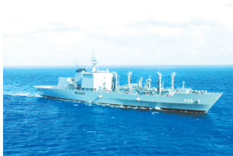
日本对补给舰的航速要求极高,促使“摩周”级用了昂贵的全燃动力系统。
