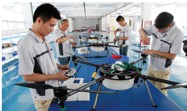
工人在安装调试植保无人机
