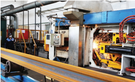
焊轨机在进行自动焊轨作业
