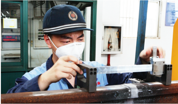
技术人员精密测量焊接钢轨
