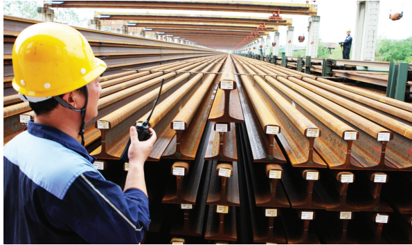
工作人员现场指挥成品轨吊装作业
