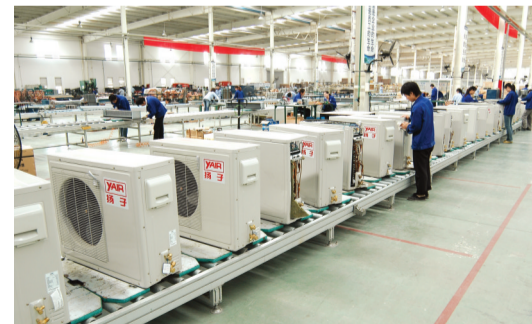
滁州家用空调外机生产线
