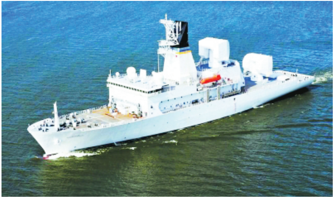
两块厚厚的“板砖”，上面的是S波段雷达，下面是X波段雷达
