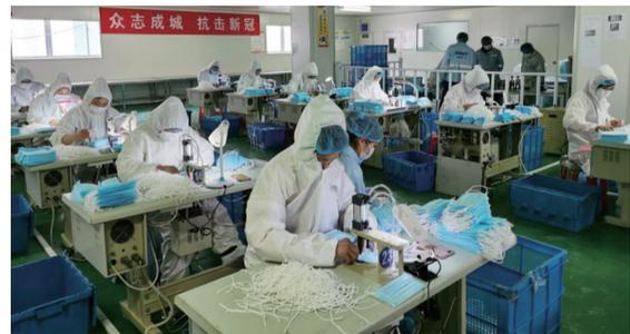
安徽安恒纸塑制品有限公司内，工人正在加紧生产口罩
