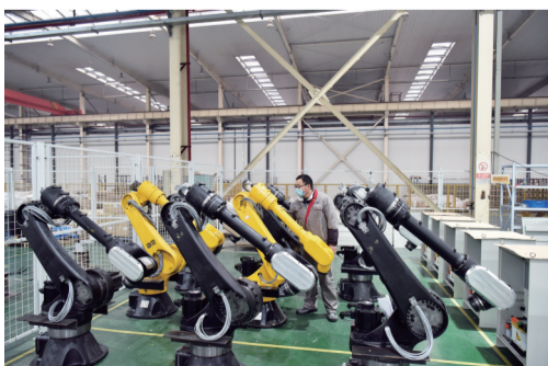
大富科技的工作人员正在检查生产好的工业机器人
